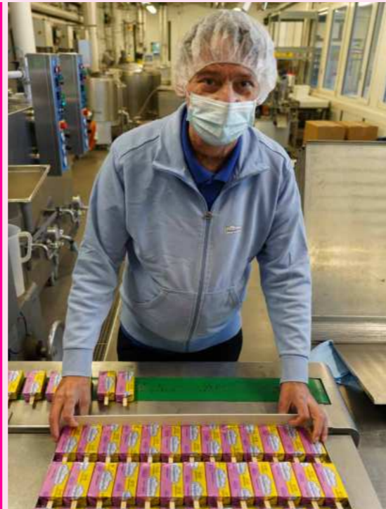
Sorgfältige Arbeit: Die noch weichen Stängel werden von einem Mitarbeitenden aufs Blech geschoben, bevor diese durchgefroren werden.
